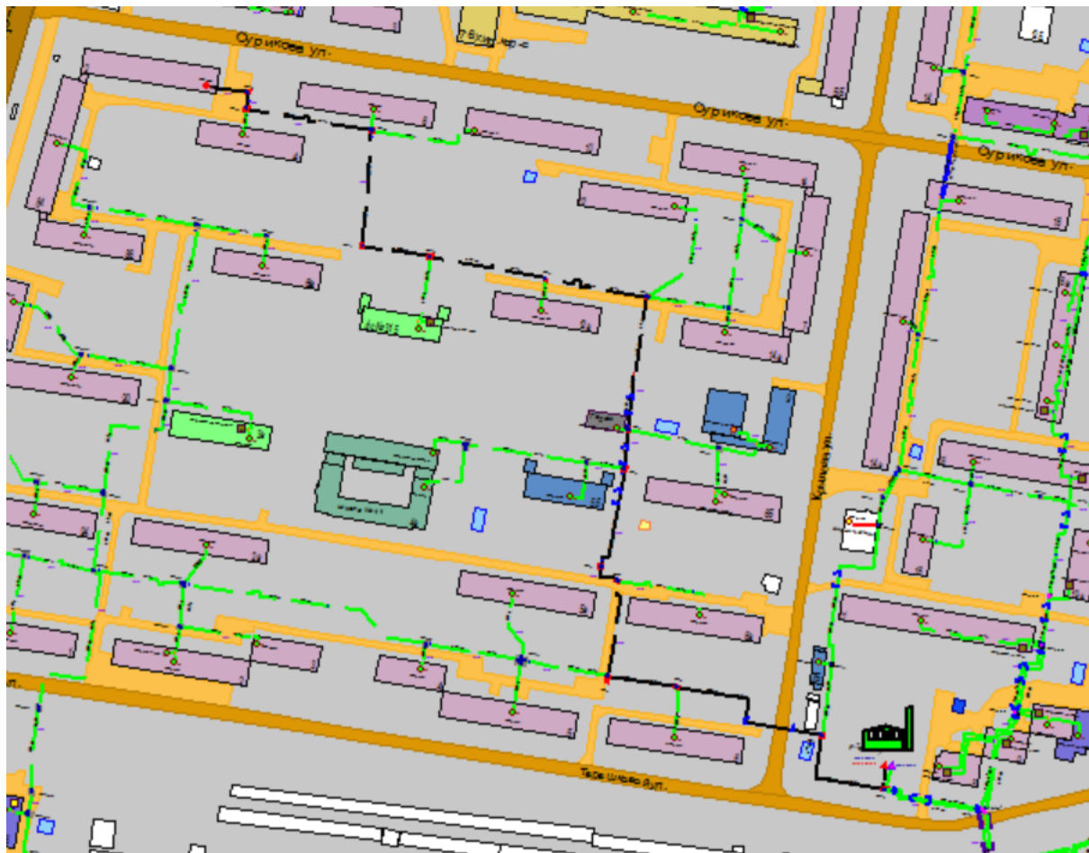
Рисунок Ошибка! Текст указанного стиля в документе отсутствует..221 Результат гидравлического расчета - расчетный путь теплоносителя от котельной Терешковой, 7 до ПТ-Сурик,2
