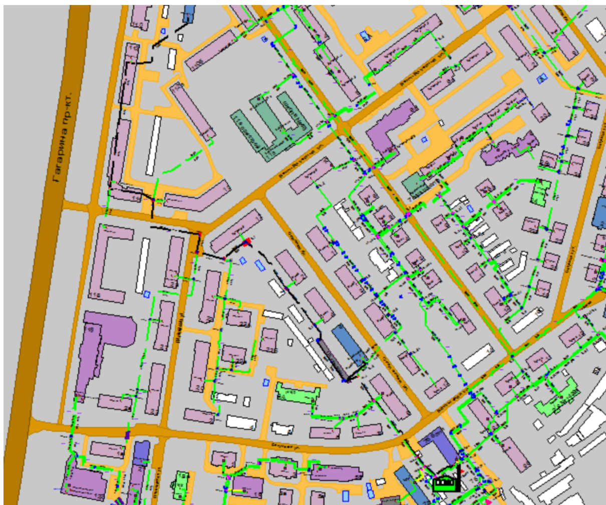
Рисунок Ошибка! Текст указанного стиля в документе отсутствует..27 Результат гидравлического расчета - расчетный путь теплоносителя от котельной Углова, 7 до ПТ-Гагар.пр.110в
