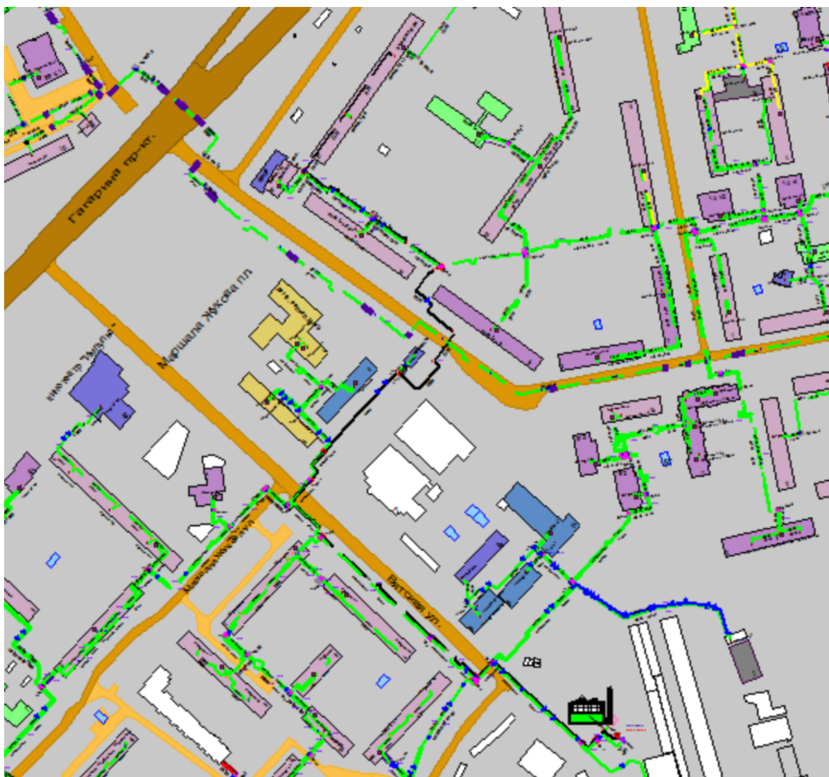
Рисунок Ошибка! Текст указанного стиля в документе отсутствует..35 Результат гидравлического расчета - расчетный путь теплоносителя от котельной ул. Голованова, 25-а до ПТ-Гагар.пр,184 з2
