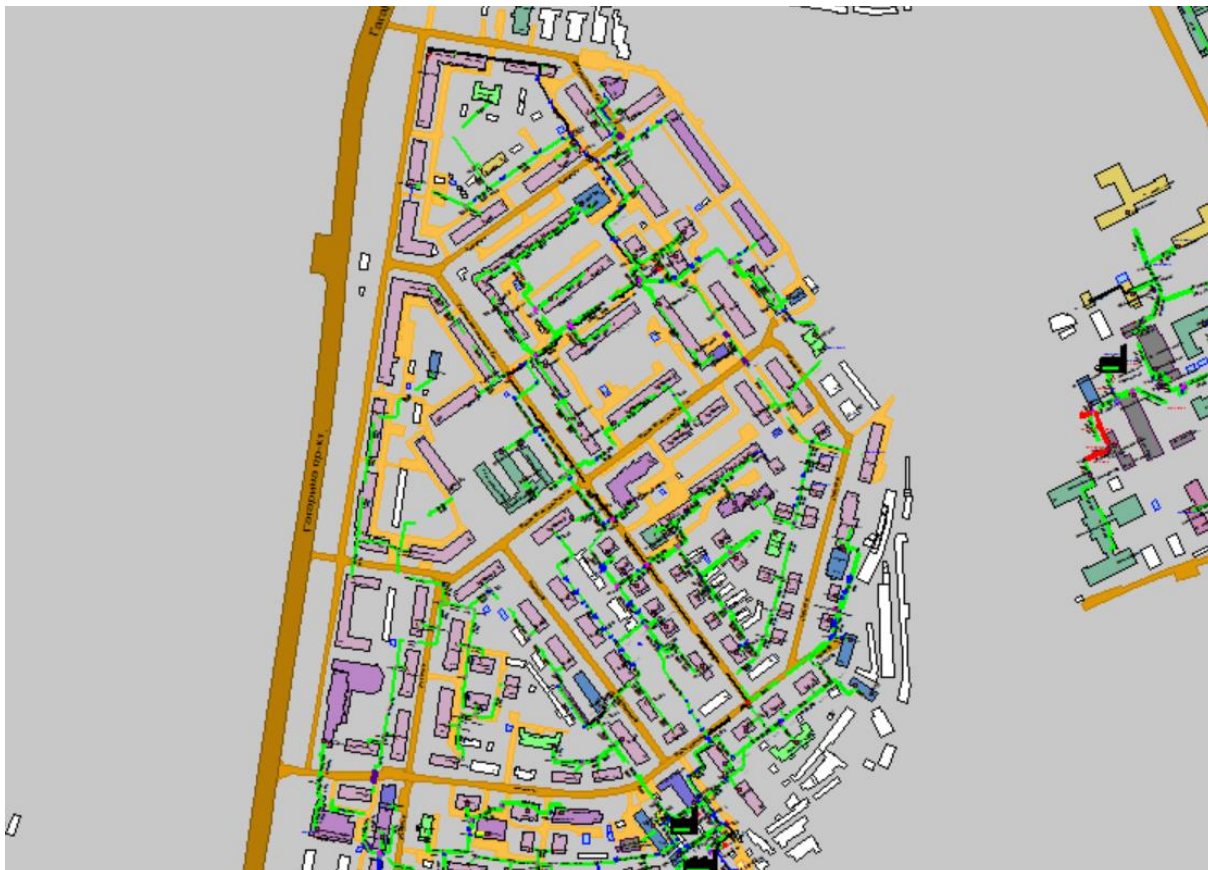
Рисунок Ошибка! Текст указанного стиля в документе отсутствует..225 Результат гидравлического расчета - расчетный путь теплоносителя от котельной ул. Батумская, 7-б до ПТ-Гагар.пр,104 э2
