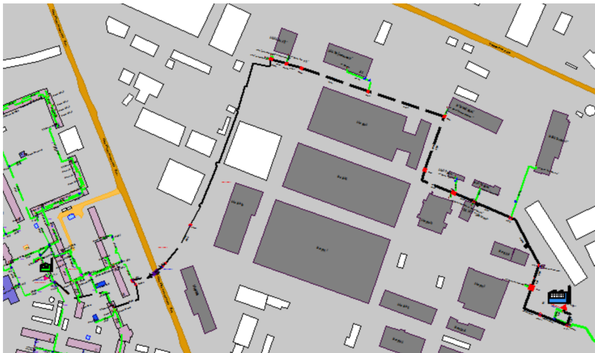
Рисунок Ошибка! Текст указанного стиля в документе отсутствует..211 Результат гидравлического расчета - расчетный путь теплоносителя от котельной Федосеенко, 64 до ЦТП-510
