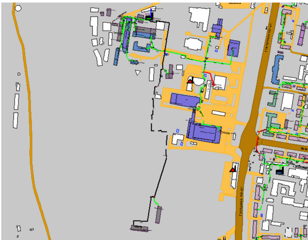
Рисунок Ошибка! Текст указанного стиля в документе отсутствует..53 Результат гидравлического расчета - расчетный путь теплоносителя от котельной Гагарина, 25-е до ПТ-Гагар.пр,31 хлор
