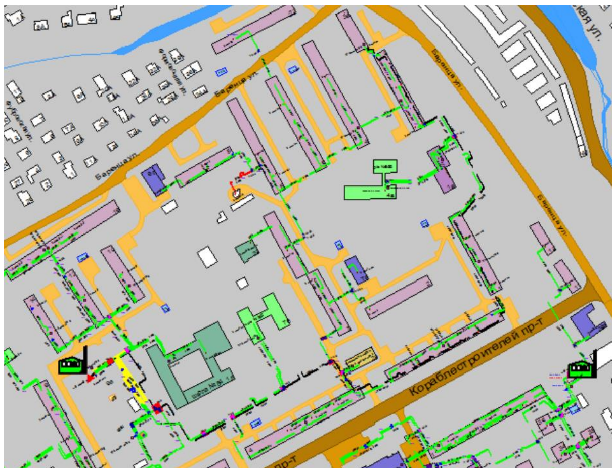
Рисунок Ошибка! Текст указанного стиля в документе отсутствует..69 Результат гидравлического расчета - расчетный путь теплоносителя от котельной Баренца, 9а до ПТ-Барен.3а
