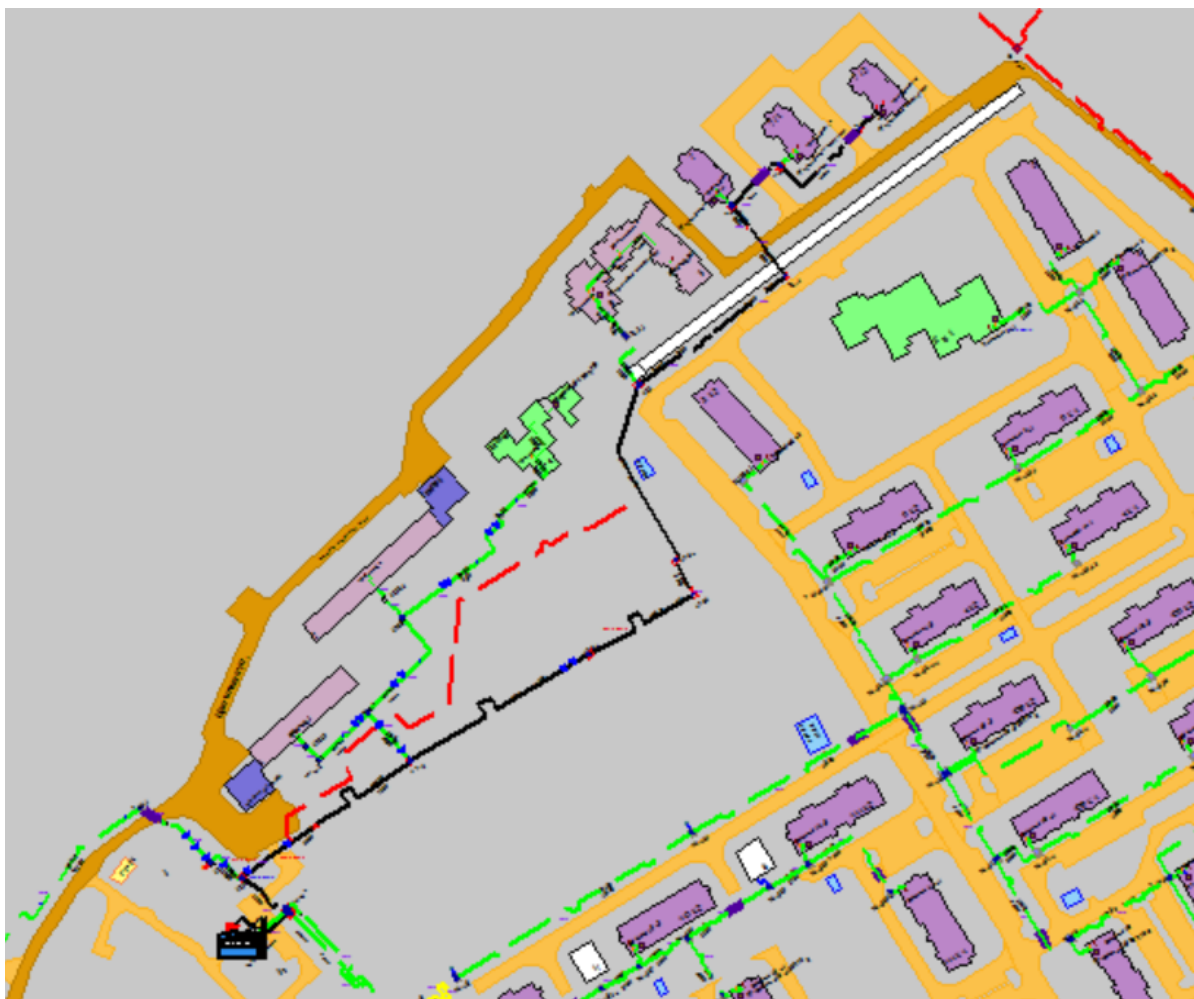
Рисунок Ошибка! Текст указанного стиля в документе отсутствует..47 Результат гидравлического расчета - расчетный путь теплоносителя от котельной Цветочная, 3-а до ПТ-Цветочная,7/2
