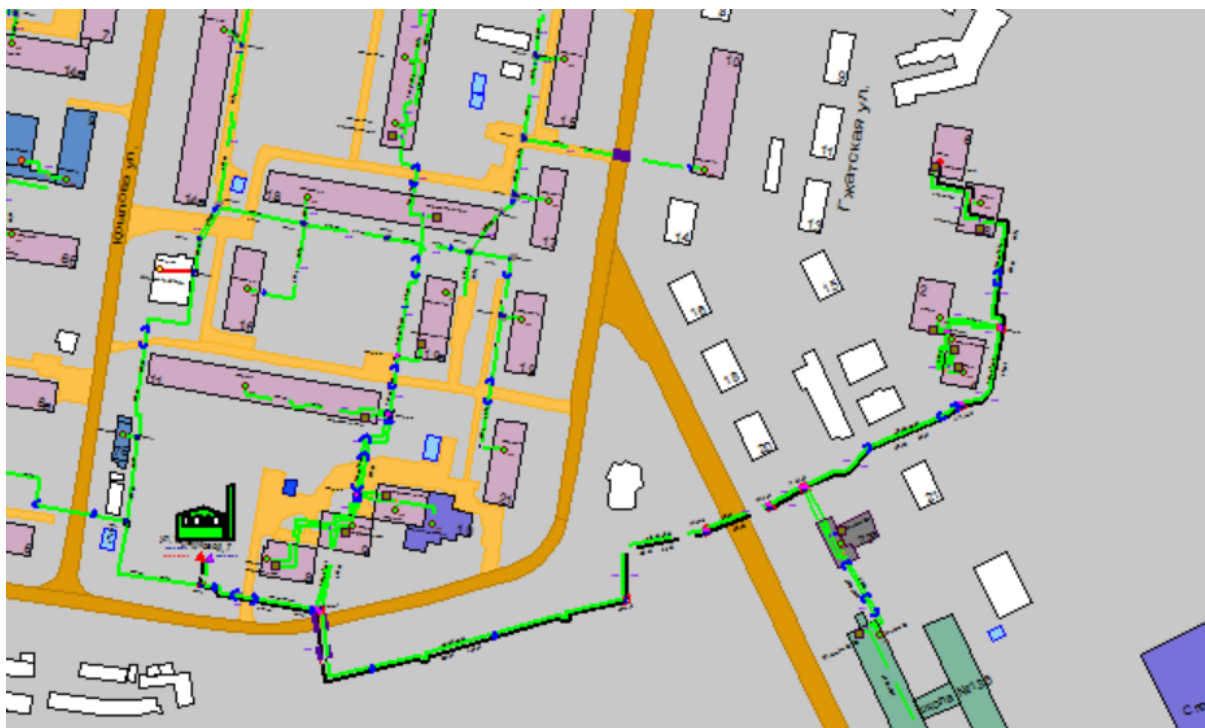
Рисунок Ошибка! Текст указанного стиля в документе отсутствует..217 Результат гидравлического расчета - расчетный путь теплоносителя от котельной Терешковой, 7 до ПТ-Гжат,6
