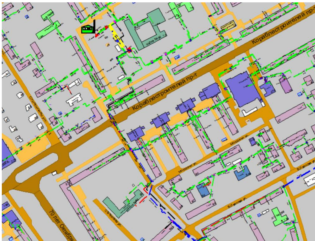
Рисунок Ошибка! Текст указанного стиля в документе отсутствует..71 Результат гидравлического расчета - расчетный путь теплоносителя от котельной Баренца, 9а до ПТ-Иван.55а
