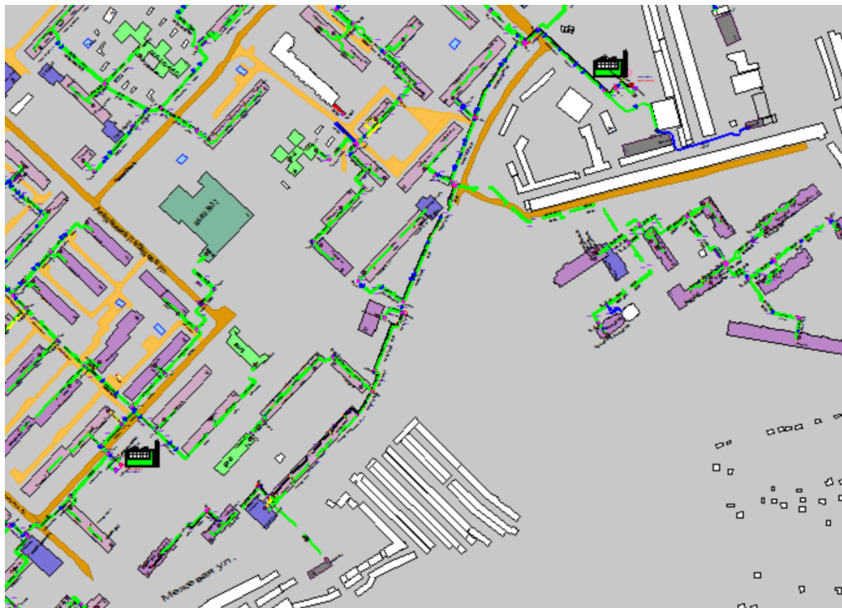
Рисунок Ошибка! Текст указанного стиля в документе отсутствует..37 Результат гидравлического расчета - расчетный путь теплоносителя от котельной ул. Голованова, 25-а до ПТ-Голован,57 э2
