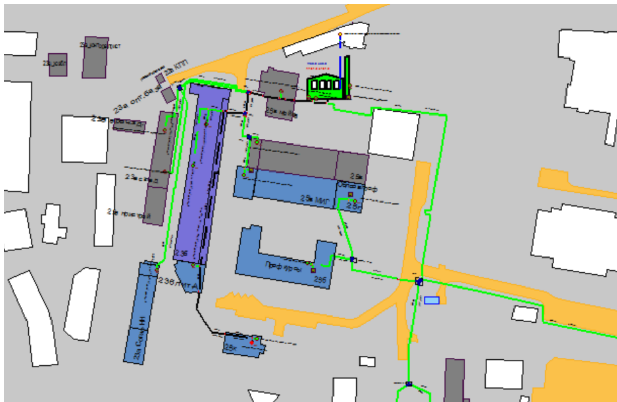
Рисунок Ошибка! Текст указанного стиля в документе отсутствует..55 Результат гидравлического расчета - расчетный путь теплоносителя от котельной Гагарина, 25-е до ПТ-Гагар.пр,25к
