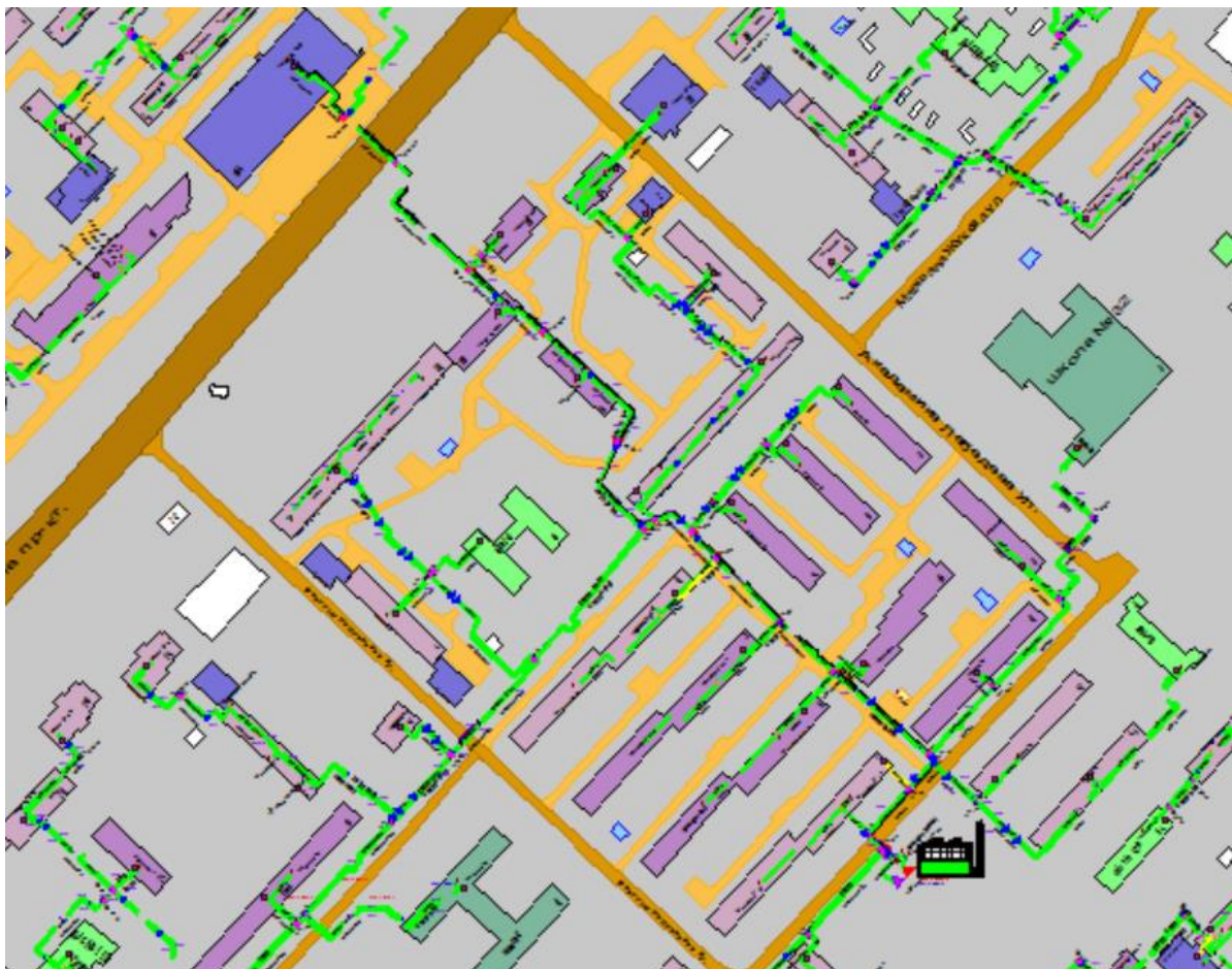
Рисунок Ошибка! Текст указанного стиля в документе отсутствует..33 Результат гидравлического расчета - расчетный путь теплоносителя от котельной Военных комиссаров, 9 до ПТ-Гагар.пр,105а
