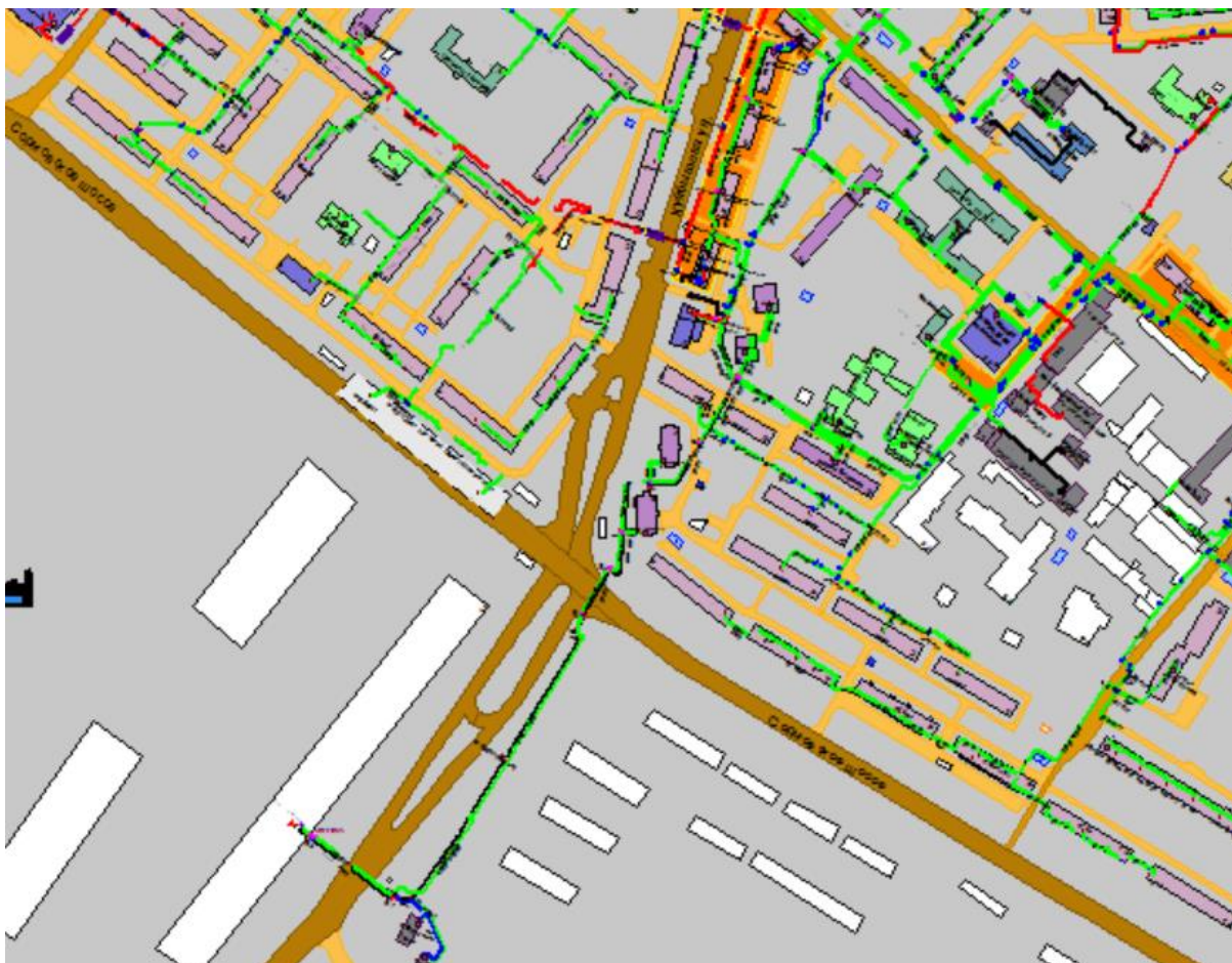
Рисунок Ошибка! Текст указанного стиля в документе отсутствует..233 Результат гидравлического расчета - расчетный путь теплоносителя от котельной Бурнаковский пр., 15 до ПТ-Куйбыш,32,30
