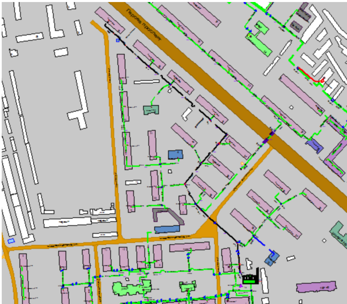
Рисунок Ошибка! Текст указанного стиля в документе отсутствует..21 Результат гидравлического расчета - расчетный путь теплоносителя от котельной Гастелло, 1-а до ПТ-Героев пр,52
