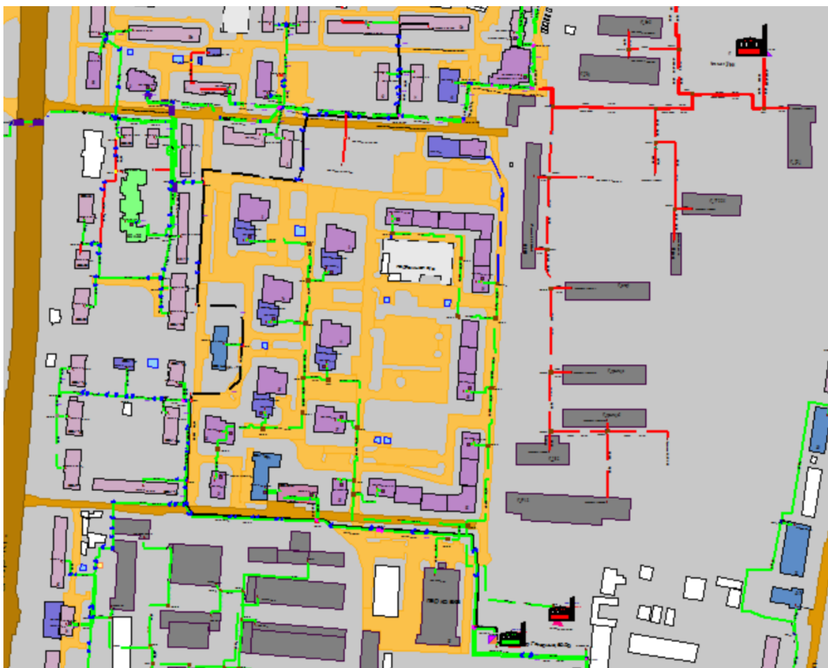
Рисунок Ошибка! Текст указанного стиля в документе отсутствует..57 Результат гидравлического расчета - расчетный путь теплоносителя от котельной Гагарина, 60 корп. 22 до ПТ-Краснозв, 12а вв2
