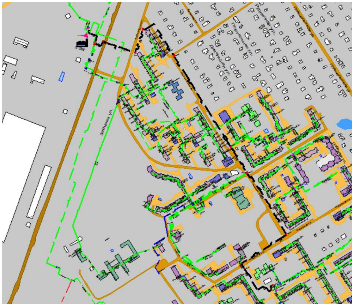
Рисунок Ошибка! Текст указанного стиля в документе отсутствует..61 Результат гидравлического расчета - расчетный путь теплоносителя от котельной Зайцева, 31 до ЦТП-504
