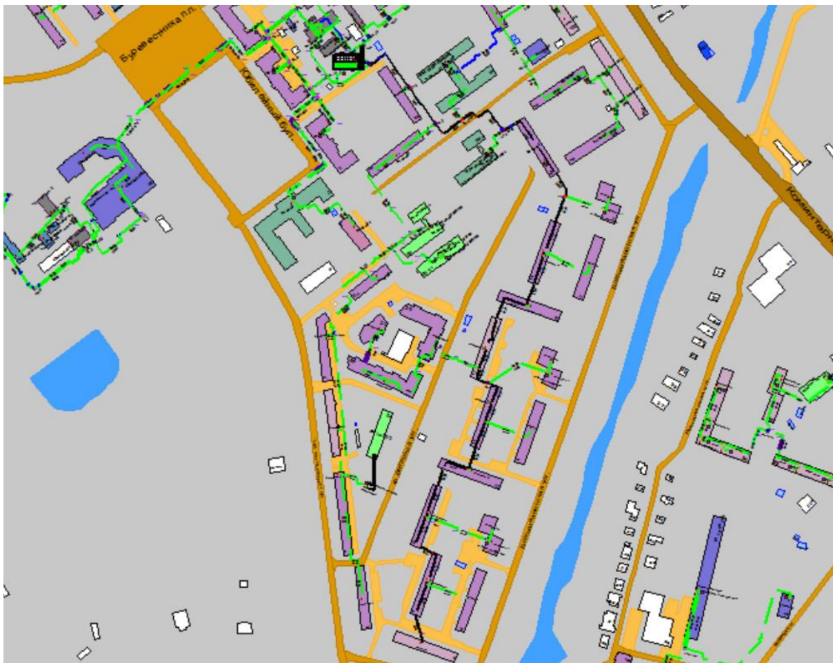
Рисунок Ошибка! Текст указанного стиля в документе отсутствует..5 Результат гидравлического расчета - расчетный путь теплоносителя от котельной Энгельса, 1-в до ПТ-Больш,7
