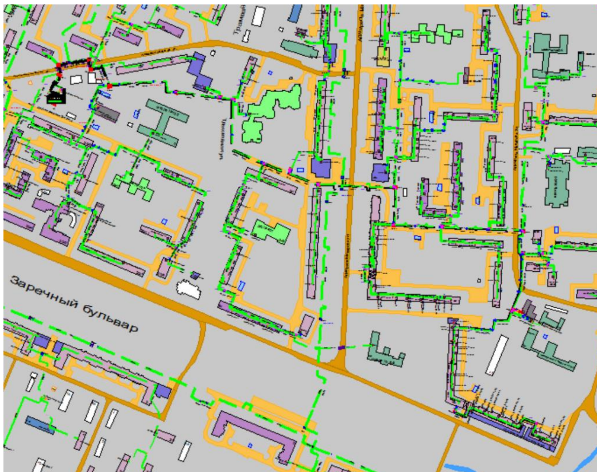
Рисунок Ошибка! Текст указанного стиля в документе отсутствует..9 Результат гидравлического расчета - расчетный путь теплоносителя от котельной Академика Баха, 4-а до ПТ-Макар, 18 э2
