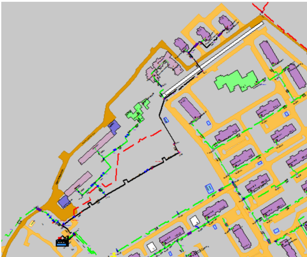
Рисунок Ошибка! Текст указанного стиля в документе отсутствует..49 Результат гидравлического расчета - расчетный путь теплоносителя от котельной Цветочная, 3-а до ПТ-Сахарова,117
