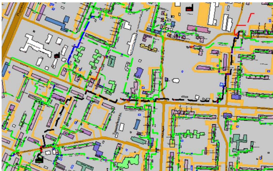
Рисунок Ошибка! Текст указанного стиля в документе отсутствует..7 Результат гидравлического расчета - расчетный путь теплоносителя от котельной Академика Баха, 4-а до ПТ-Мотал,6
