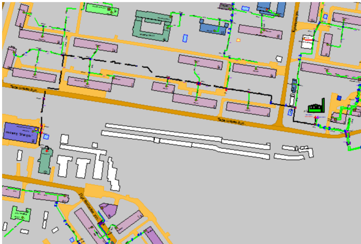
Рисунок Ошибка! Текст указанного стиля в документе отсутствует..219 Результат гидравлического расчета - расчетный путь теплоносителя от котельной Терешковой, 7 до ПТ-Гагар.пр,100
