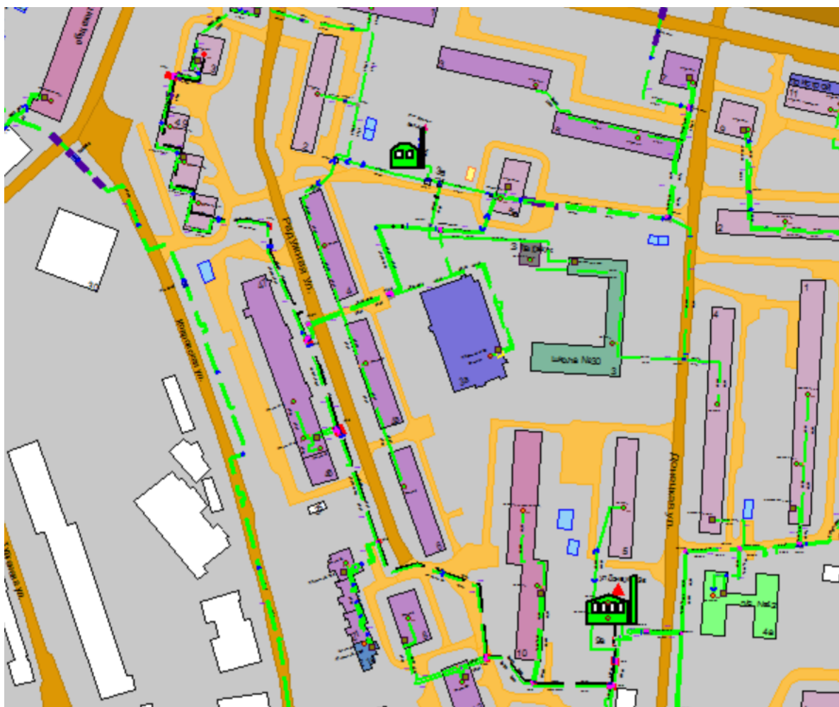
Рисунок Ошибка! Текст указанного стиля в документе отсутствует..227 Результат гидравлического расчета - расчетный путь теплоносителя от котельной Донецкая, 9 до ПТ-Радуж,3
