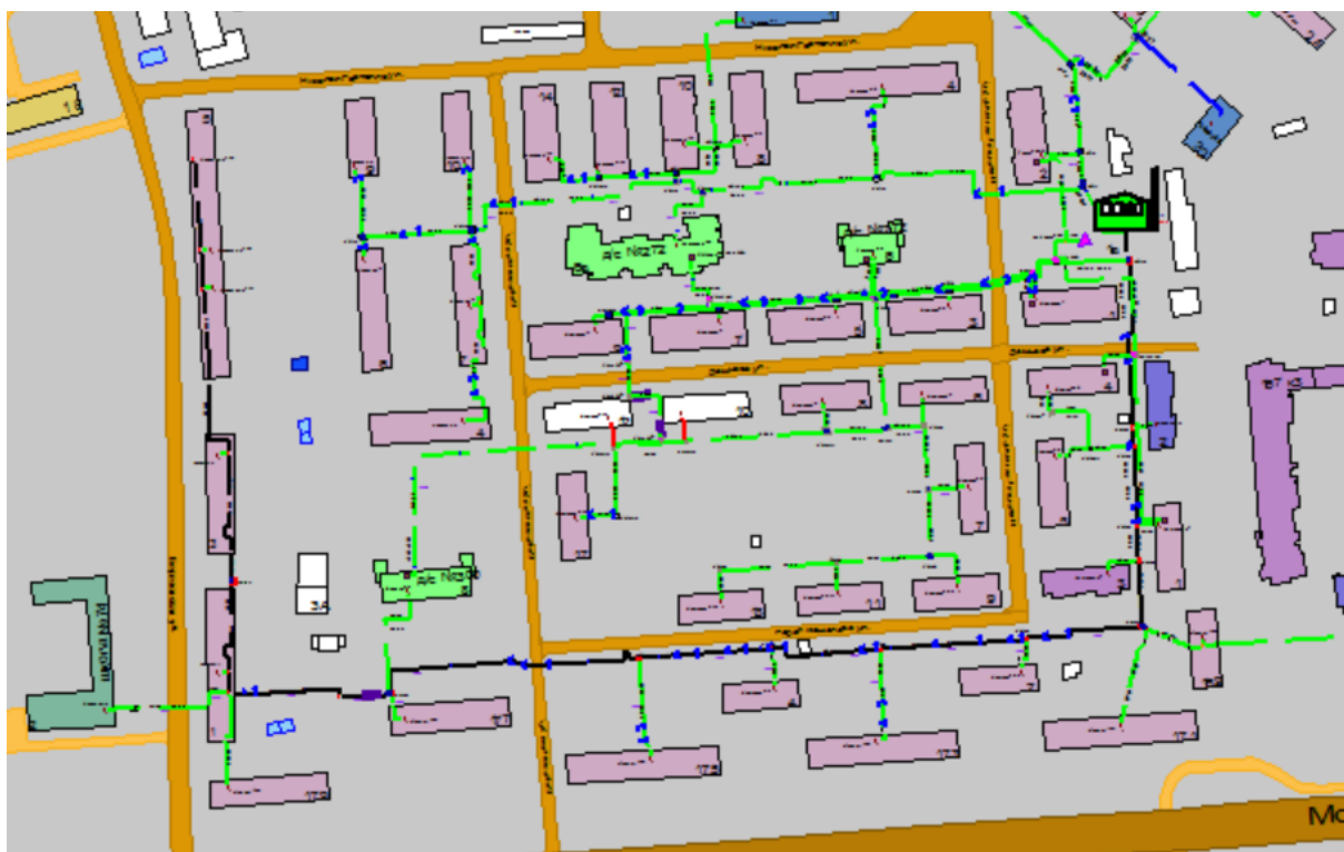
Рисунок Ошибка! Текст указанного стиля в документе отсутствует..19 Результат гидравлического расчета - расчетный путь теплоносителя от котельной Гастелло, 1-а до ПТ-Березов,5 вв3
