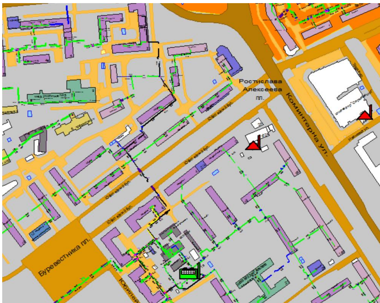
Рисунок Ошибка! Текст указанного стиля в документе отсутствует..1 Результат гидравлического расчета - расчетный путь теплоносителя от котельной Энгельса, 1-в до ПТ-Ефрем,2 з1
